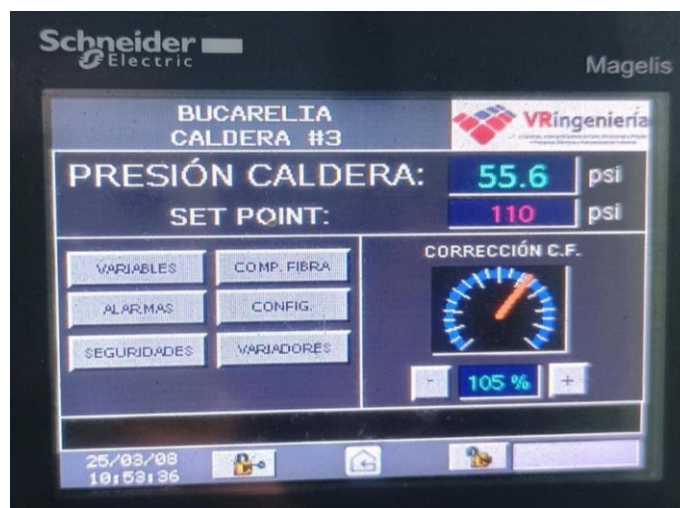
Figura 10. Pantalla HMI de la caldera
