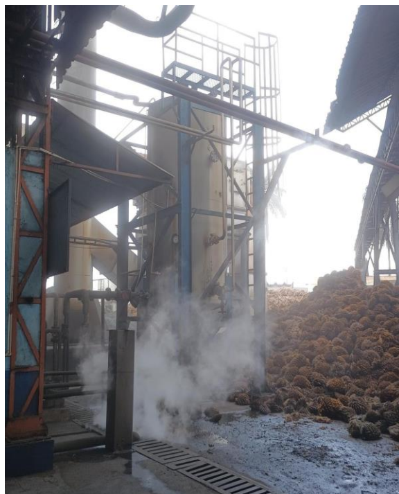
Figura 3. Tanque de precalentamiento de agua de la caldera.
